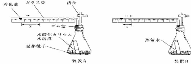
た。これらの装置は、容器内で生じた気体量の変化を目盛りつきガラス管内の着色液の移動から測定するものである。なお、装置Aのフラスコ内には20%水酸化カリウム水溶液が、装置Bのフラスコ内には蒸留水がそれぞれ入れてある。実験の操作手順は以下の通りである。
